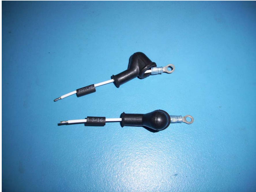
Abbildung 3 Vorbereitung der AWG14 Leitungen Figure 3 Preparation of AWG14 cables
