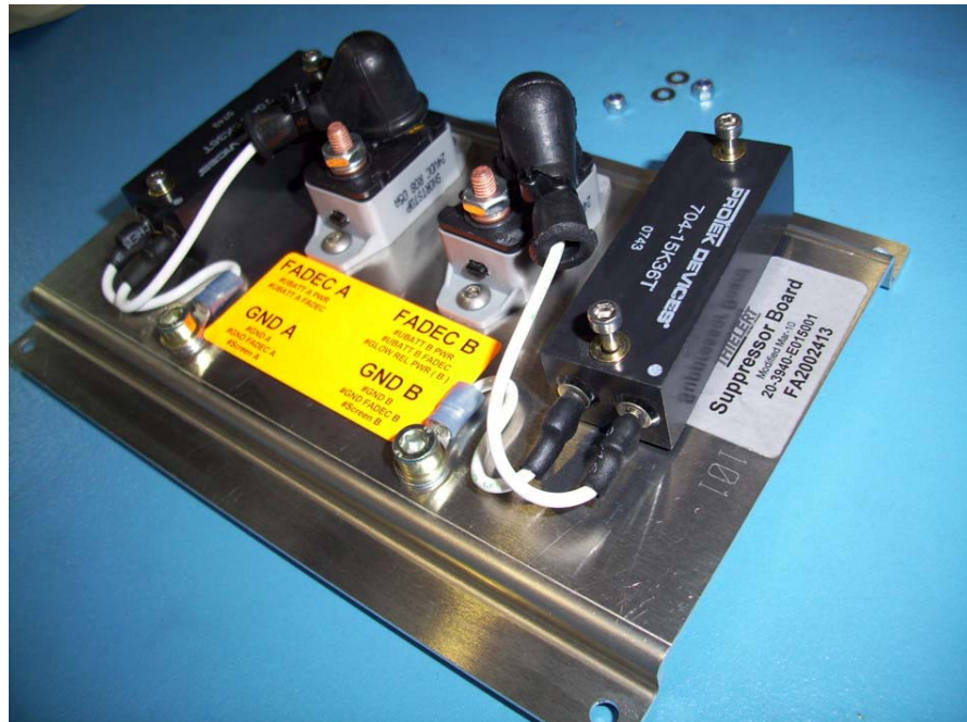
Abbildung 5 Modifiziertes Suppressor Board (TVS zum Kennzeichnen verschoben) Figure 5 Modified suppressor board (TVS moved for labeling)
