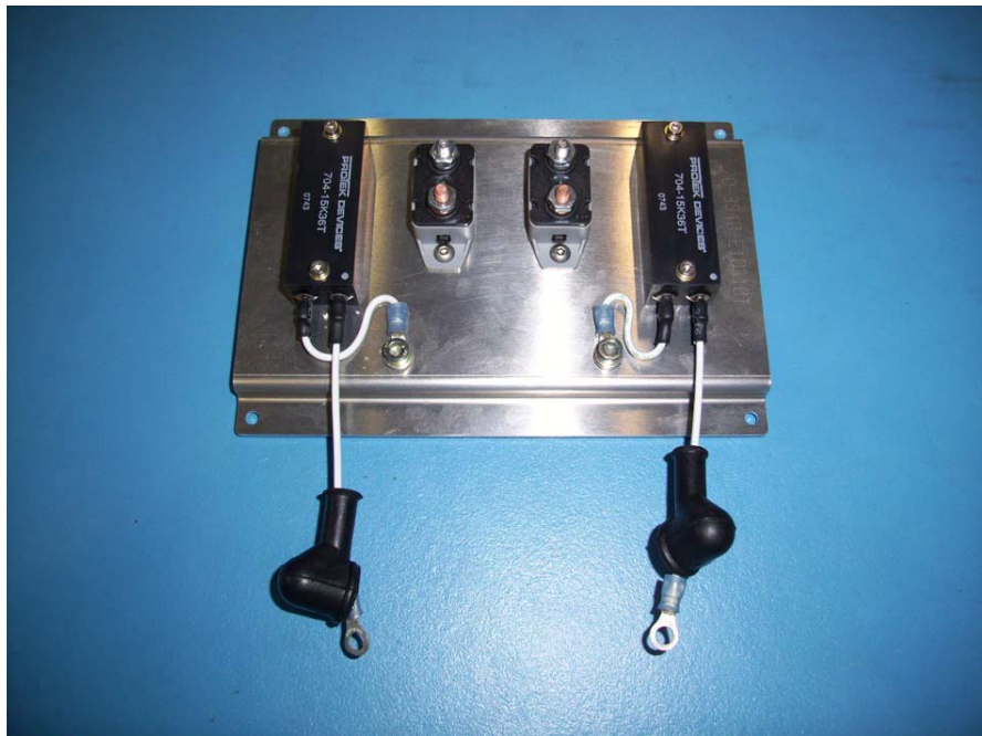
Abbildung 4 TVS mit angelöteten AWG14 Leitungen Figure 4 TVS with soldered AWG14 cables
