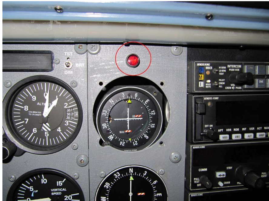
Abbildung 7 Position der Warnlampe (nur C172 R,S ohne G1000) Figure 7 Position of warning lamp (only C172 R,S without G1000)
