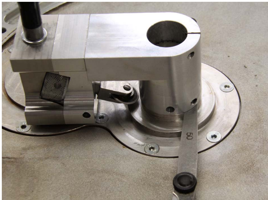
Bild 3 Abstand mit Fühlerlehre einstellen
