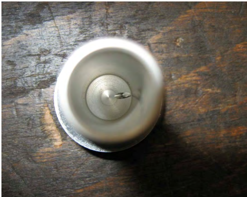
Bild 3 – Span innerhalb der Öleinfüllschraube
