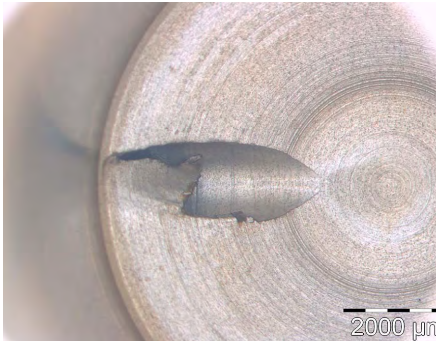
Bild 4 – Vergrößerung des Spans innerhalb der Öleinfüllschraube
