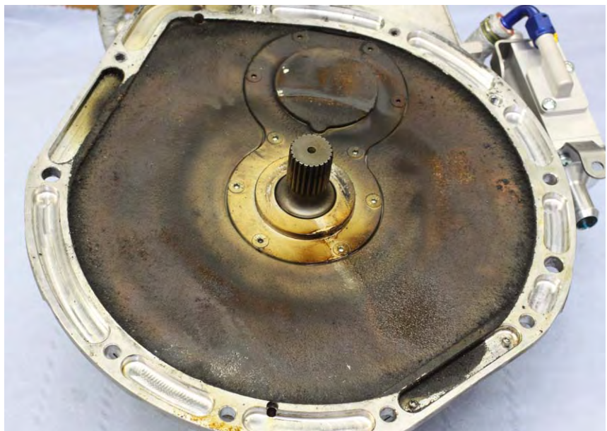
Bild 5 – Beispiel eines verrotten Getriebes
