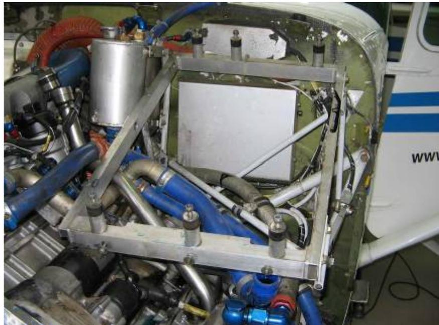
Bild 1 Halter Öl-/Wasserkühler
