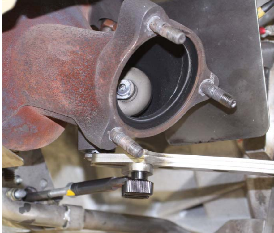
Bild 4 Befestigung des Führungswerkzeuges am Gegenhalter
