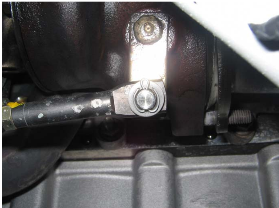
Bild 7 Befestigung des Einstellstücks am Waste-Gate-Hebel
