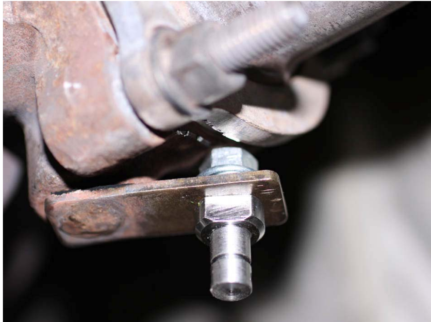
Bild 6 Befestigung des neuen Stiftes
