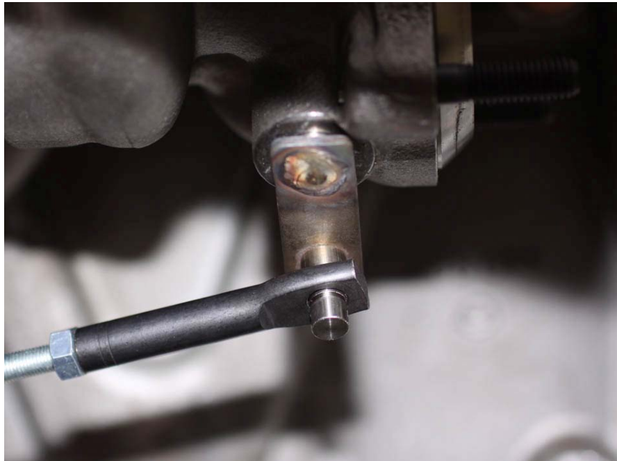
Bild 1 Einstellstück auf dem Stift des Wastegatehebels
