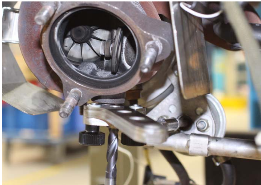
Bild 5 Bohrung zur Befestigung des neuen Stiftes bohren
