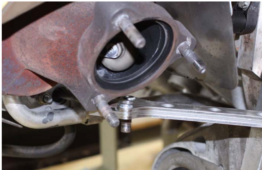
Bild 2 Wastegatehebel mit Gegenhalter in Position halten
